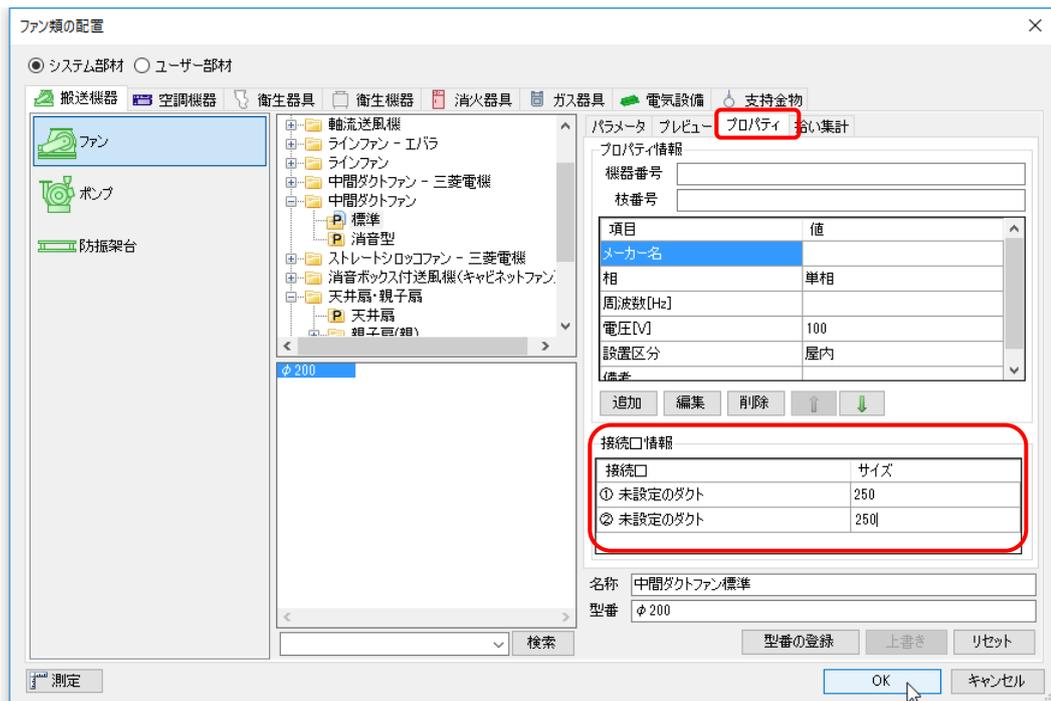
3 [接続口情報]で設定したサイズでルートが作図できます。
