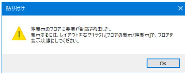
1 要素を貼り付けるフロアを指定します。[貼り付け]時の[高さ]パネルで変更します。
