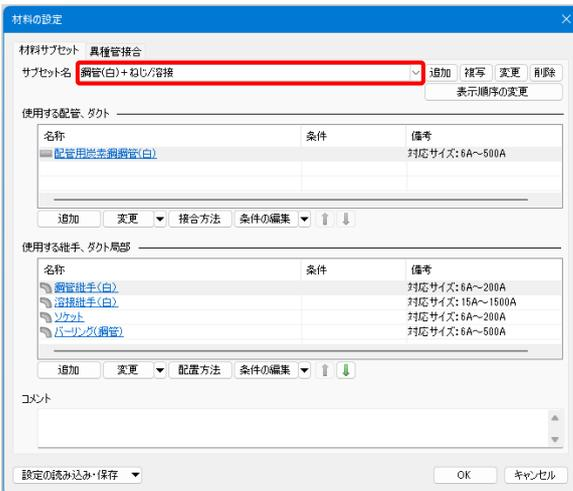
3 条件を設定する配管や継手を選択し、「条件の編集」をクリックします。
