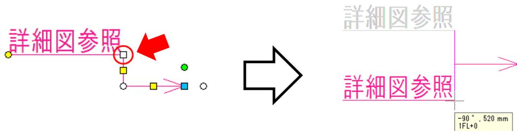
折線の場合、リボンの[引出し角度を変更する]にチェックを入れることで、移動時に引出し角度を変更することができます。
