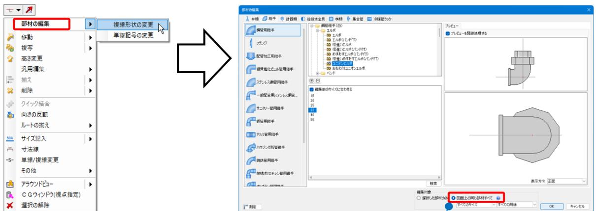
同じ継手をまとめて変更したい場合は、[部材の編集]の編集対象で「図面上の同じ部材すべて」を選択します。
