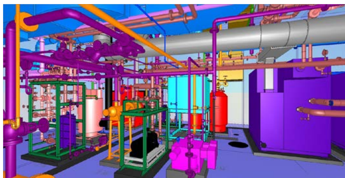
▲ 既存の配管を 3D で作図し、竣工イメージを作成。ユニットや管割は加工センターの入力により、より施工に近い形のデータが完成
