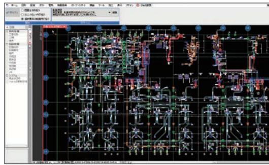
レプロのアドイン「CheX連携」を使って出力したデータをCheXに読み込み、現場の検査に使用。BIMモデルから属性情報をエクスポートし、「CheX」にデータを読み込ませることでシームレスな風量測定を実施。端末上には検査対象が自動で表示され、BIMモデル内の属性情報から設計値などの情報も反映。結果を帳票として出力も可能。
