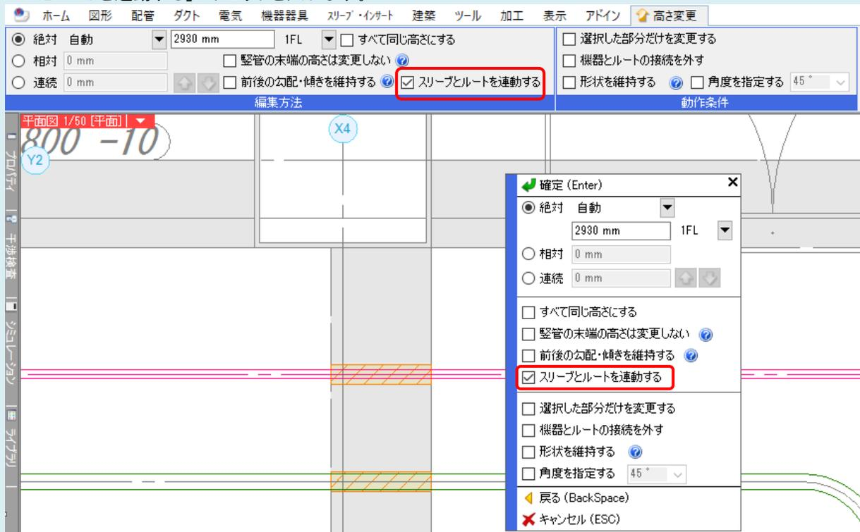
選択したルートを通しているスリーブの高さが、ルートの高さに合わせて変更されます。
