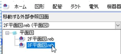
3 選択した図面を移動します。移動の基準点(外部参照図面の原点)からラバーが表示されます。
