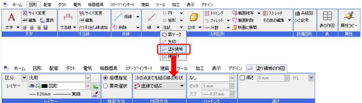
2 [次の点までを結ぶ線の形状]とハッチングの種類、ピッチ、太さを選択します。
