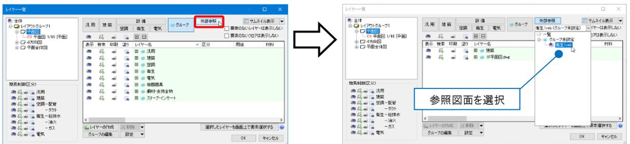
2 外部参照している図面のレイヤーが表示されます。[梁符号]レイヤーを非表示にし、[OK]をクリックします。
