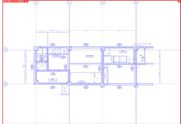
1 [レイヤー一覧]を開き、[外部参照]をクリックします。[一覧]をクリックし、制御する外部参照図面を選択します。
