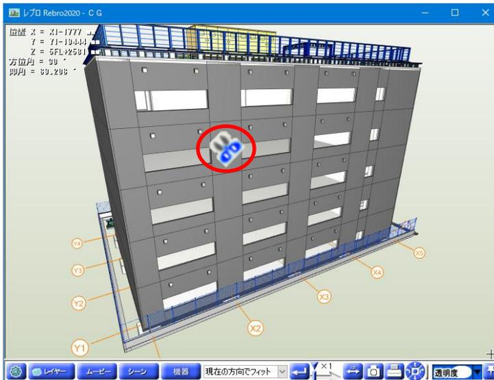
断面カットのカーソルを左ドラッグすると、カットする位置を面の直交方向に移動できます。
