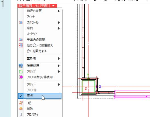
読み込んだ2枚の建築図の原点が違う場合、どちらかの図面を移動します。ここでは「1階平面図」の原点位置まで「2階平面図」を移動します。
