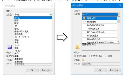
「新規図面」を選択後、[OK]をクリックします。 4 「設定]ダイアログを「OK]で閉じるとクイックアクセスツールバーにコマンドが追加されます。
