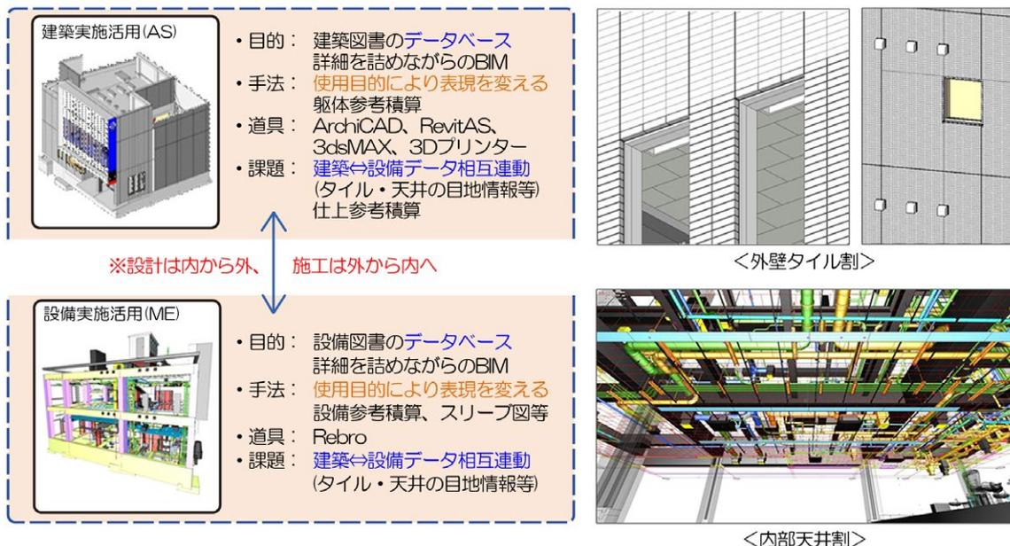
▲意匠モデルの内部の天井割や外壁のタイル割と設備モデルを連動させることで手戻りを防止する
