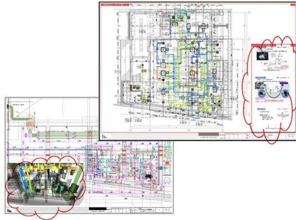
▲ BIM モデルから大判カラープリンターで印刷した施工図。3次元パースでダクトや配管などの細部の納まりを表したほか、図面の隅には施工管理基準なども貼り付け、分かりやすくした
