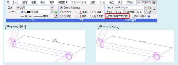
作図後に寸法値の向きを変更したい場合は、[プロパティ]で[寸法値]-[向き]を、[画面方向に向く]に変更します。
