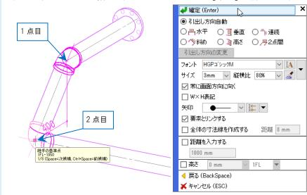
3 コンテキストメニューの[引出し方向の変更]をクリックすると、引出し方向を指定するハンドル(水色)が表示されます。
