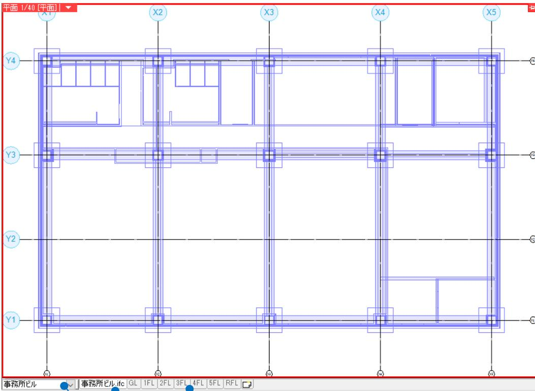
読み込んだ IFC ファイルのフロアごとにレイアウトを分けて表示します。
