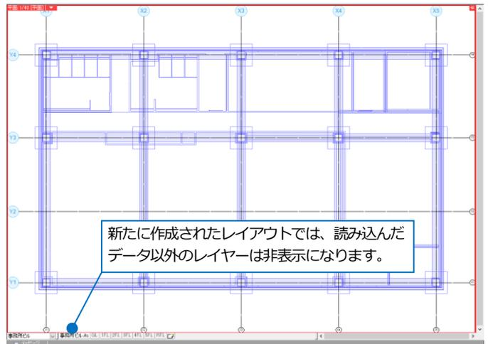
レイアウトを切り替えると元の図面に重ねて表示されます。
