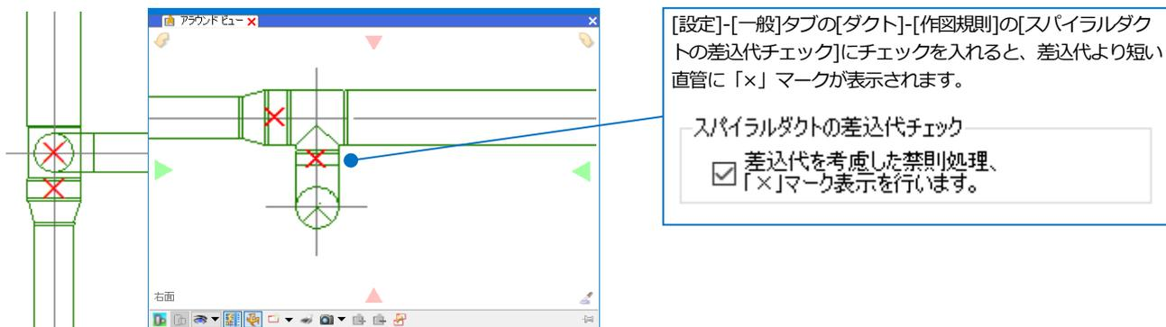
レボでは、矩形ダクト・円形ダクト・スパイラルダクトの直管の加工可能な最短長さを設定することができます。最短長さより短い直管には「×」マークが表示されます。
