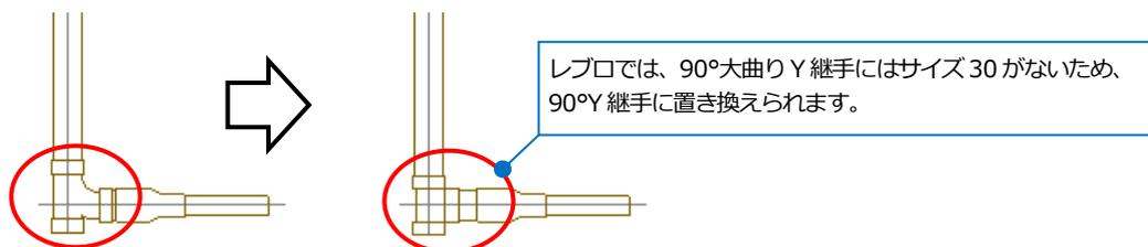
ふさわしい部材がない場合、汎用図形として元の形状のまま表示されます。
