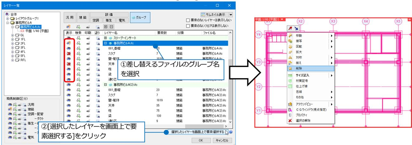
「建築」などの区分に切替え、ファイル名をクリックし、コンテキストメニューから[ファイル名の変更]でファイル名の(2)を消して、元の図面と同じファイル名に変更します。[ファイル名の変更]ダイアログが表示され、[はい]をクリックすると、元の図面のレイヤーと統合されます。
