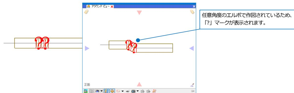
レプロに合致する部材がない場合、類似する部材に置き換えられます。
