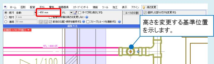
高さ変更する配管に勾配が設定されている場合、基準高さの位置をオレンジのハンドルをクリックして移動することができます。
