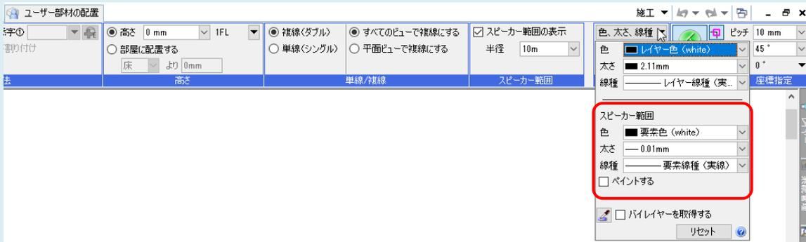
スピーカー範囲の設定を配置後に変更したい場合は、配置したスピーカーを選択し、[プロパティ]から設定できます。
