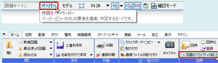
[プロパティの選択]ダイアログで記入する項目を選択し[OK]をクリック後、図枠上で記入位置をクリックします。図面のプロパティに入力した内容が、図枠に反映されます。
