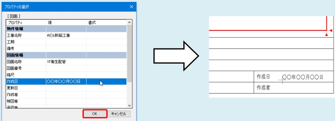
プロパティで入力した内容を削除しても、[図面のプロパティの記入]で記入した設定は残ります。作図モードを[ペーパー]に変更すると、項目名に{ }がついて表示されます。
