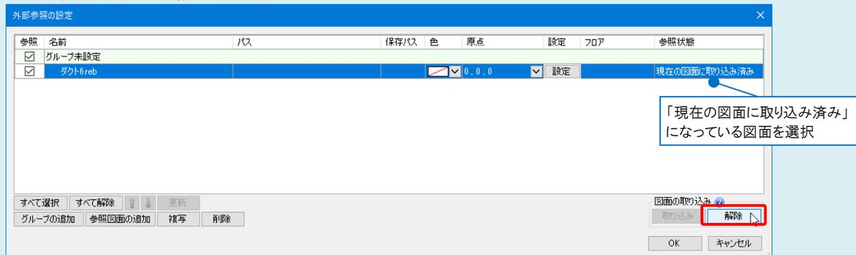
元図面に取り込んだ外部参照図面が解除され、外部参照した図面を編集できるようになります。
