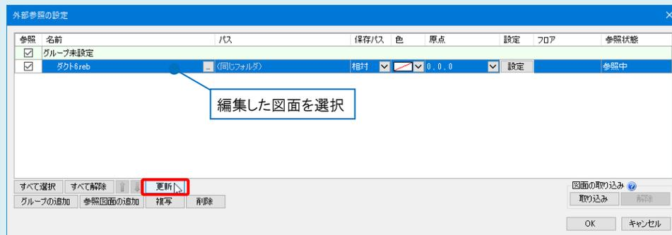
また、外部参照元の図面を開き直すと、外部参照図面は自動更新されます。
