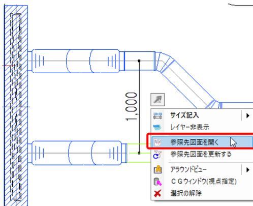
外部参照図面が開きます。参照元図面で選択していた要素が[検索]パネルの検索結果に表示されます。この図面で編集を行い、上書き保存をします。
