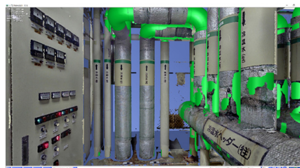
配管の曲面にテクスチャとして貼り付けし、パイプの用途種別なども確認できる。
