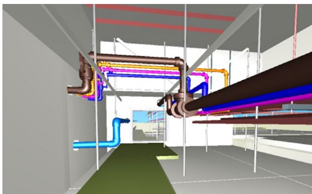
▲3D画像 天井内メンテナンス歩廊
