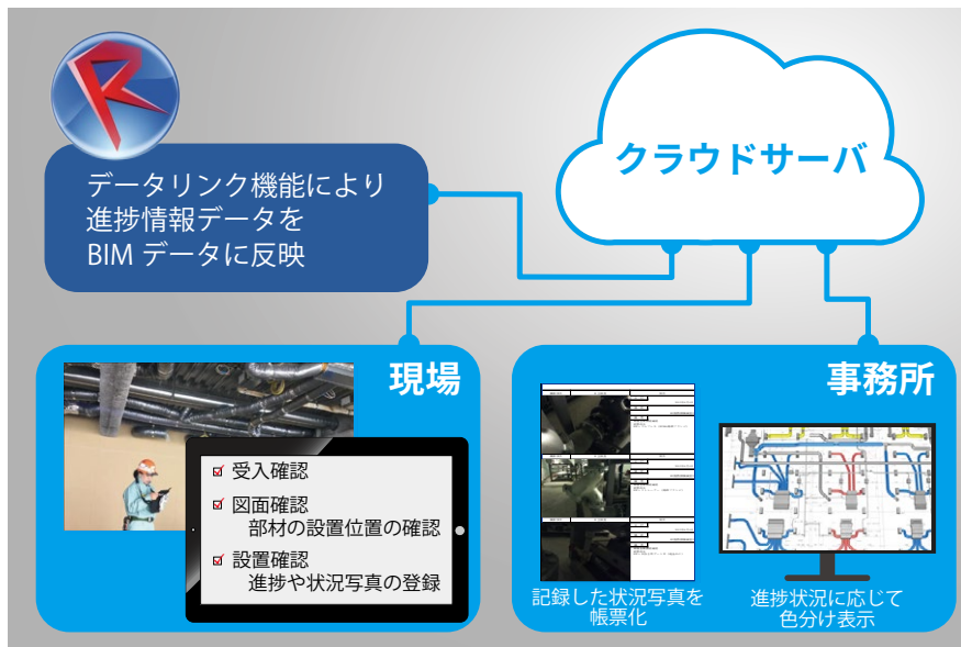
▲ BIM データを利用した工事進捗管理イメージ
