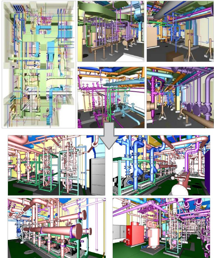
▲現地調査を元に作った施工図をベースに、施工図→完成後のイメージを作成
