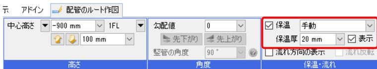
作図後に保温を設定する場合は、[配管]タブ-[保温]から設定します。
