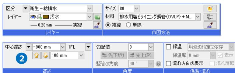
3 ガイドメッセージに『配管を作成する位置を指定します。』と表示されます。メイン管上をクリックして接続します。
