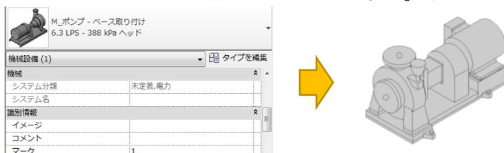
レプロ: 部材 = 「搬送機器」-「渦巻ポンプ - エバラ」-「FS 型」-「4 極形 60Hz」-「80×65FS4H63.7」に割り当て
