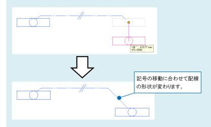
配置済みのシンボルを置き換える場合は、シンボルを選択し、右クリックのコンテキストメニューから[部材の編集]-[単線記号を基準にリセット]で[単線形状]にチェックを入れて置き換えます。
