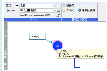
3 シンボルを登録します。登録の手順は FAQ「<u>電気シンボルを登録したい</u>」をご確認ください。 既に登録されているシンボルに接続口を追加する場合は、シンボルを選択し、右クリックのコンテキストメニューから[編集]をクリックします。
