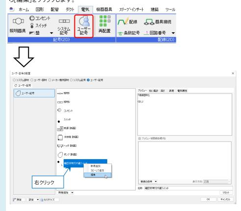
4 [単線記号の編集]ダイアログで[削除]をクリックし、再度[登録]をクリックします。シンボルと単線記号用接続口を選択し、[OK]をクリックして登録をします。
