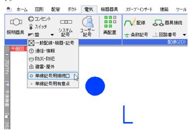
接続口の設定で「電気配線用」を選択し、接続口の位置を指定します。
