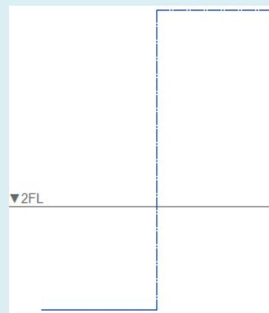
[立上り]/[引下げ]記号から横引きの配線を作図する場合は、縦方向の配線が重複しないように記号の高さを設定します。
