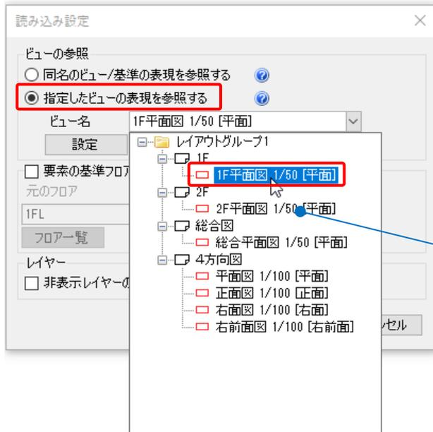
参照先図面でスプリンクラーヘッドの放水円を表示しているビュー名を選択します。
