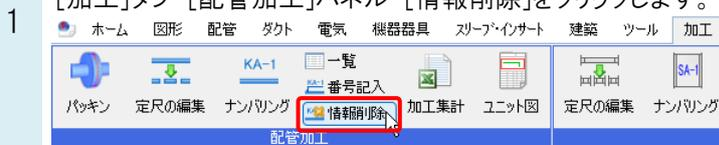
2 配管には複数のナンバリング項目を設定できるため、削除するナンバリングの種類を指定すると、ルート上に選択した種類の番号が表示されます。情報を削除するルートを選択します。
